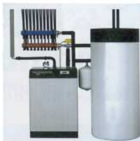
Die kompakte Wärmepumpe - hier mit Warmwasserspeicher - ist ein anschlussfertiges System, das am Aufstellungsort keine kältetechnische Montage erfordert. Über eine Schnittstelle wird sie mit der Erdsonde verbunden, die mit einem Glykol-Wasser-Gemisch gefüllt ist
